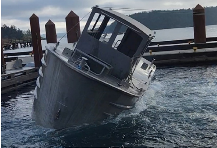
Wheel House, plongeur assistant à la direction - Des instructeurs des opérations tactiques maritimes de la GRC participent à un exercice de formation sur un bateau chaviré au large de la jetée D de la BFC Esquimalt, le 17 janvier. Le bateau d'entraînement spécialement conçu qu'ils utilisaient est doté de plusieurs compartiments étanches qui lui permettent de flotter à l'envers et d'ajuster la poche d'air à l'intérieur. Photo de la GRC : GRC
